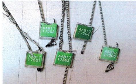
5. EVALUACIÓN. Las muestras ensayadas cumplen con el requerimiento carga máxima especificado en la norma ISO17712:2013 (E) C-TPAT, cuyo valor de carga establece un mínimo de 10 kN (1022.7 kgf), toda vez que el valor medio obtenido en 5 muestras fue de 10.41 kN (1062 kgf).
